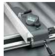
DIGIT X - digitální zobrazení šíře řezu do 1300mm
